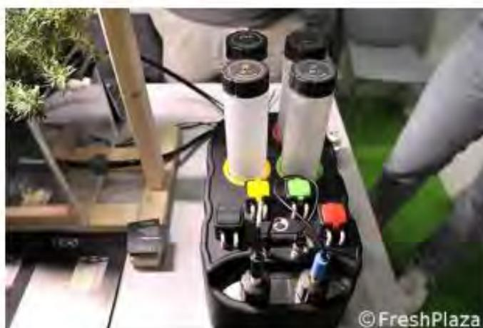
"Il nostro sistema di gestione automatizzata - spiega Andrea Carloni - si installa in pochi minuti. Bastano due fori passanti nella vasca della soluzione nutritiva per rendere la serra automatizzata e connessa. E' compatibile con qualsiasi impianto idroponico già esistente. E' ideale per qualsiasi soluzione fuorisuolo fino a 2500 litri di soluzione nutritiva complessiva dell'impianto".
